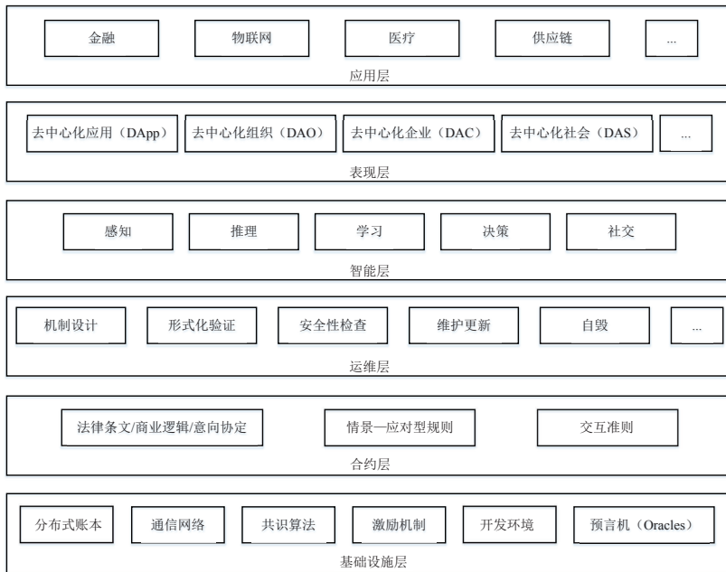
图 2 智能合约基础架构模型
