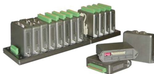
2005年推出第二代基于32位CPU的RTU— Super32—体化RTU和Super E40模块化RTU
