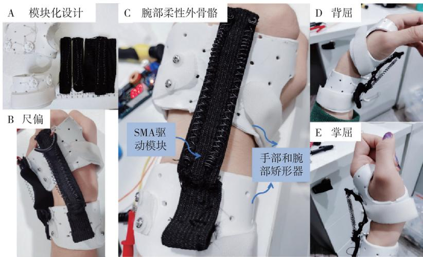
图4 基于 SMA 仿生驱动模块的腕部柔性外骨骼设计
