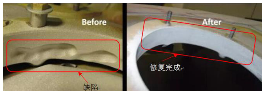
图4 3D打印用于零件修复
